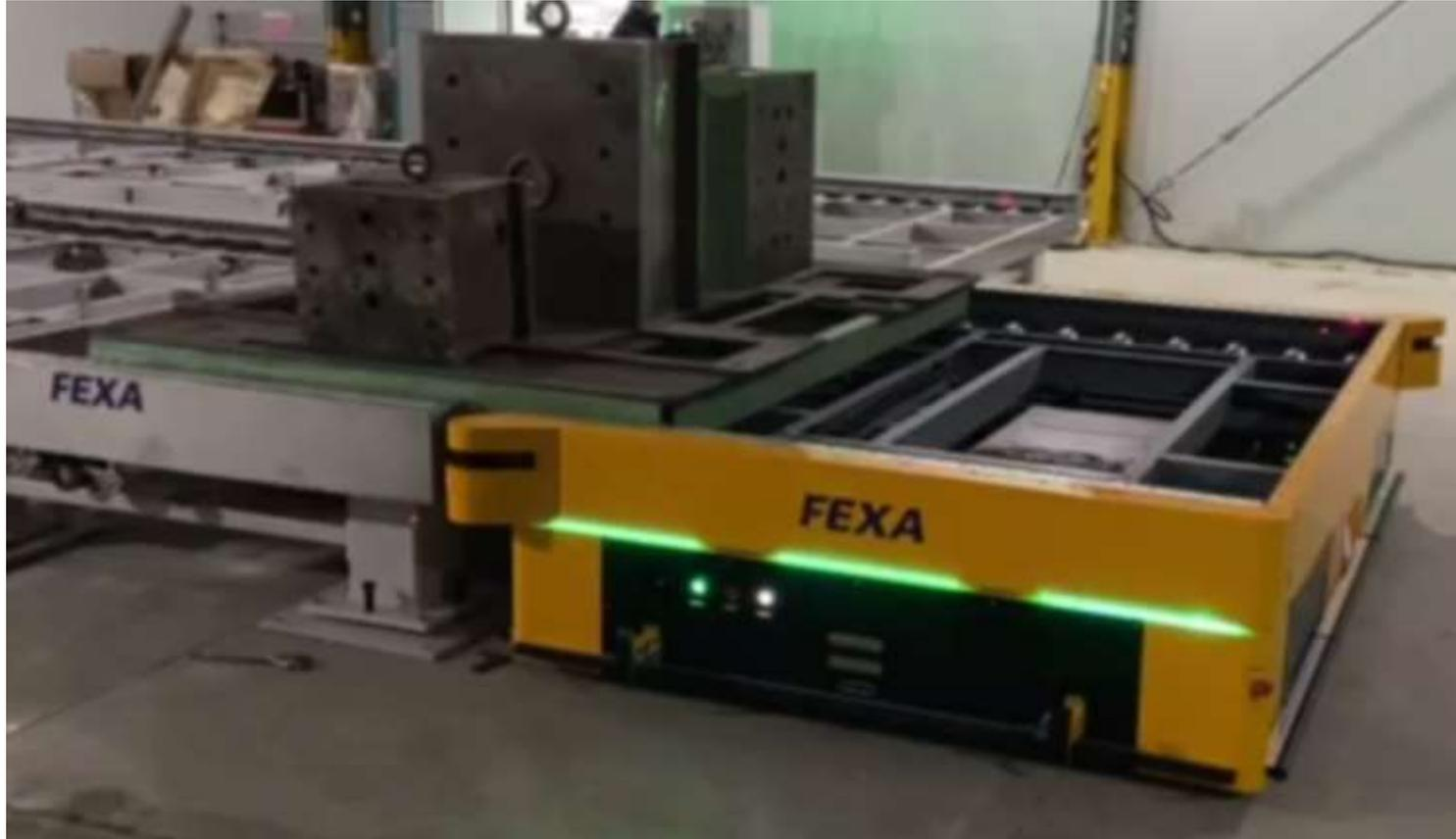
ユニットロード+ローラータイプF-IGV、積載5トン、生産ラインとの間に±2mmの位置決め精度を実現
