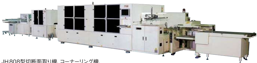
JH808型切断面取り機、コーナーリング機、レーザー板厚測定機、刻印機
