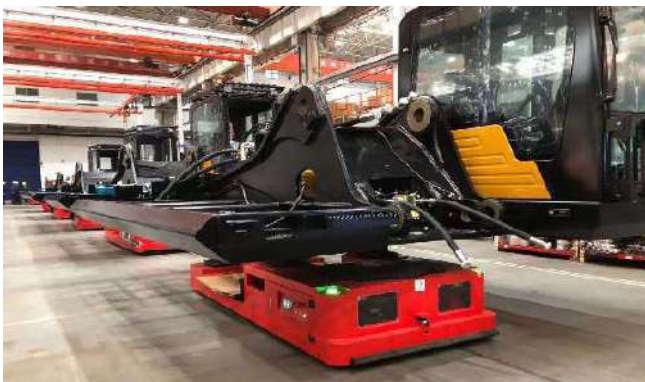
大型ショベルカーの組み立てライン
