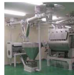
自動粉体混合設備
