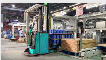
ライン側倉庫と生産ラインの接続
