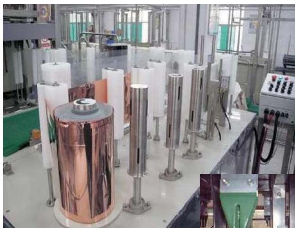
上クランプ式縦型ロール・to・ロール銅メッキ装置 (フレキ専用)
